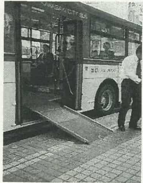
スロープバスのスロープはかなり急角度。車いすで自力で乗車するのは難しく、運転手の介助が必要
