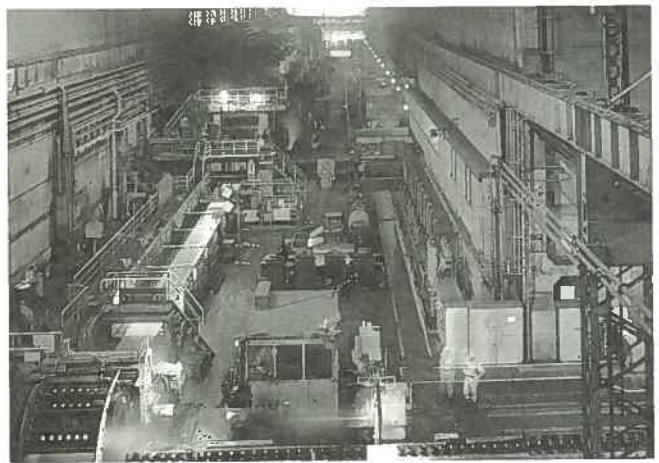
写真3 圧延機後テーブル上の熱帯 高温帯状の熱延製品が水冷されながら30m後方のコイラー（巻取り機）により巻き取られている様子。約1時間の高速加熱と唯一パスの高圧下圧延で表面のスケール発生が少なく艶のある優れた表面品質と微細な結晶粒による優れた機械的性質の熱帯製品が生まれる。写真の熱帯の表面に見られる艶は他の圧延機では削り出せない。
