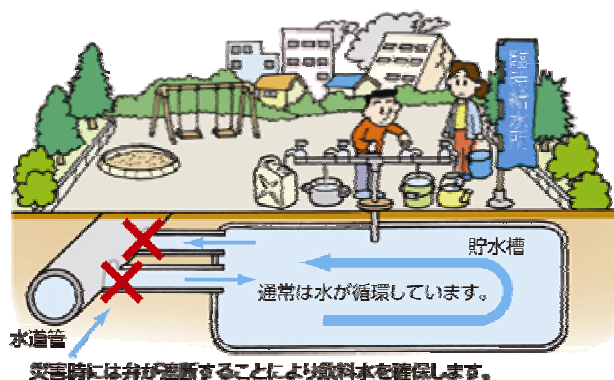
災害対策用貯水槽のしくみ
