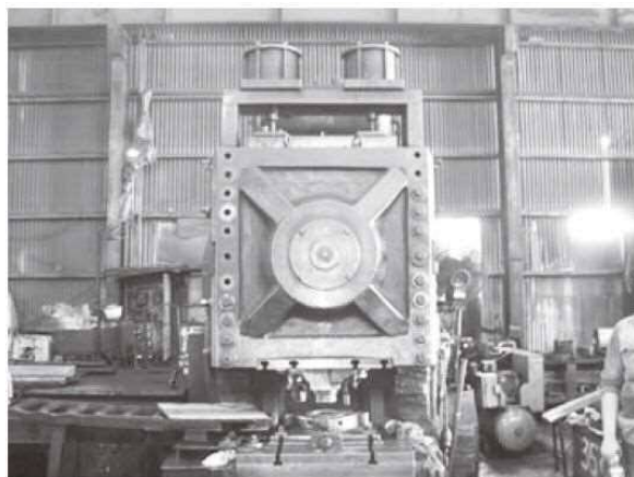
1000t プレス クランク方式による、最大28mm厚、380mm径のプレスができます。
