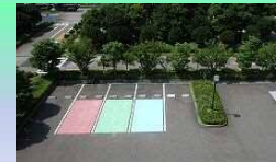
事業者と連携した路面塗装による遮熱効果の実証実験
