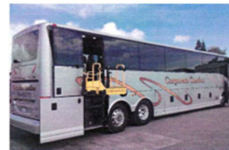
リオ大会でBPAが選手の移送等に使用した車両。車いすのまま乗車できるよう、改造されている。
