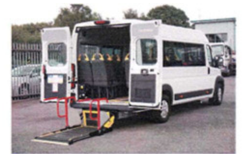
リオ大会でBPAが選手の移送等に使用した車両。車いすのまま乗車できるよう、改造されている。
