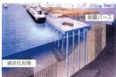
東扇島9号岸壁の耐震改修
