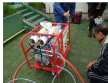
非常用浄水装置
