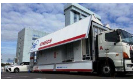
川崎マリエン移動式水素ステーション
