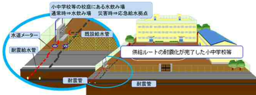
開設不要な応急給水拠点の設置
