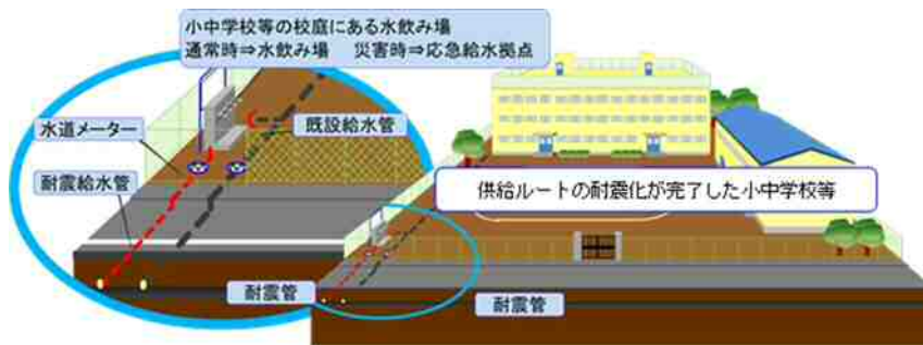
開設不要な応急給水拠点の設置
