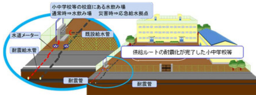
開設不要な応急給水拠点の設置
