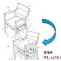
椅子からの立ち上がりをアシストする 「起立補助椅子」(宮崎県延岡市の企業の例)
