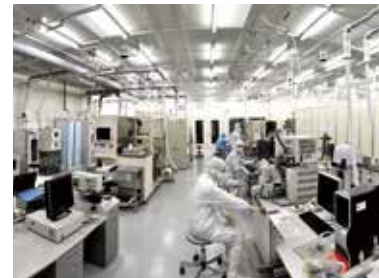
クリーンルーム クラス10000(約575m 2 )
