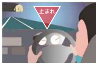
運転情報等をフロントガラスに表示するヘッドアップディスプレイ
