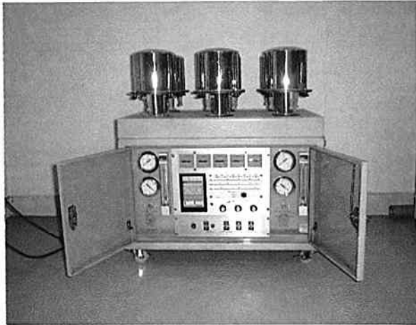
図5 風向別大気粉じん捕集装置
