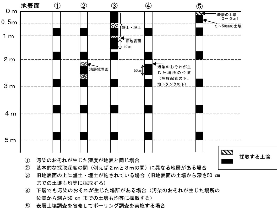
図1－6 ボーリング調査における土壤試料の採取深度の参考例
