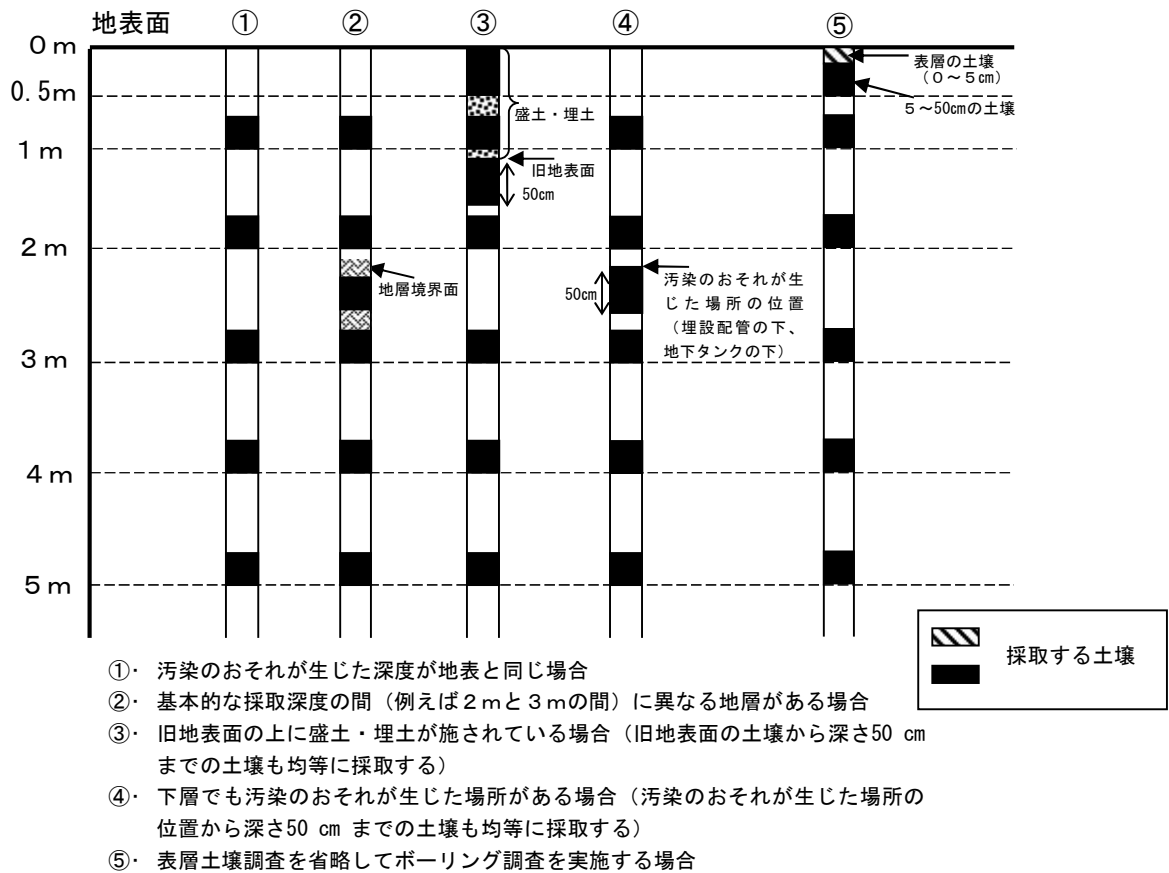
図1-6 ボーリング調査における土壌試料の採取深度の参考例 (重金属等(ダイオキシン類を除く。))
