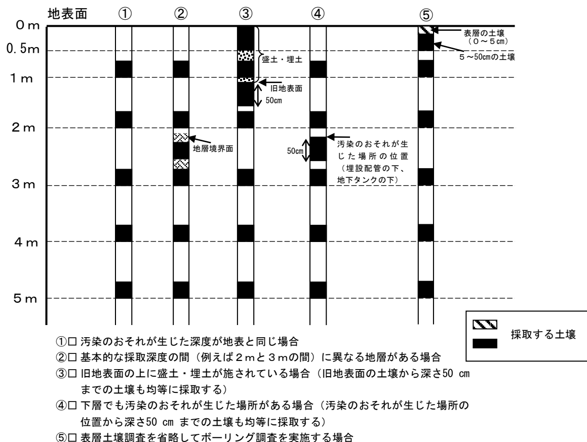
図1-6 ボーリング調査における土壤試料の採取深度の参考例 （重金属等（ダイオキシン類を除く。））
