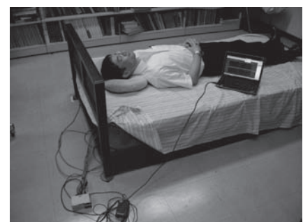
圧電センサーにより寝ている人の心拍等を測定
