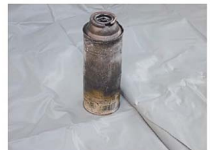
発火原因と考えられるカセット式ガスボンベ
