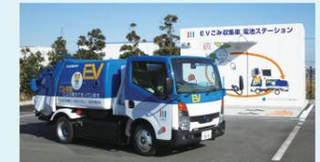
EVごみ収集車(電池交換型)の導入
