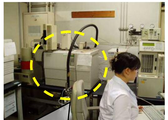
トリハロメタンは、「ガスクロマトグラフ・質量分析計（GC/MS）」で測定します。
