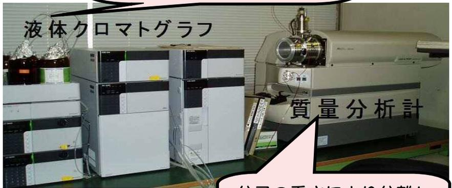
分子の重さにより分離して測定する装置です。
