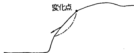
図 3.3.2 崩壊面の位置
