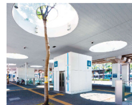
バス島上屋にトップライトを設けることで、明るい空間を確保しエレベーター・エスカレーターを増設
