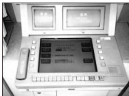
タッチパネル以外に、押しボタンを設置したもの
