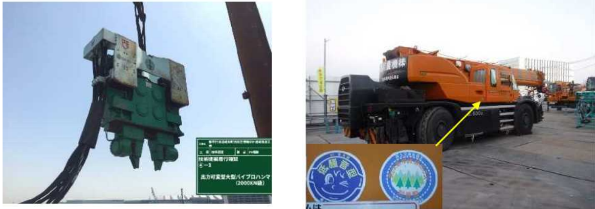
図 2.30 特殊バイブロハンマ使用（左）、低騒音型建設機械（右）
