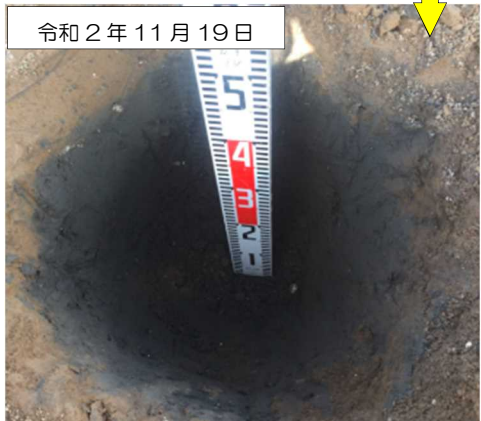
保管土の土中の状態 (約 0.5m 堀下げ)
