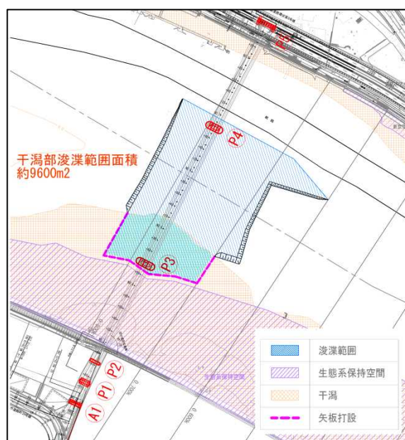
図 2.11 H29～H31 (R1) 年度工事の浚渫範囲
