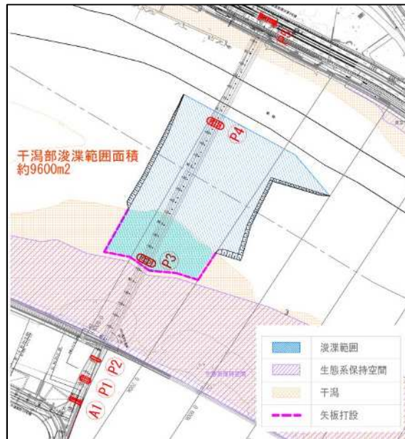
図 2.2.12 H29 年度工事の浚渫範囲
