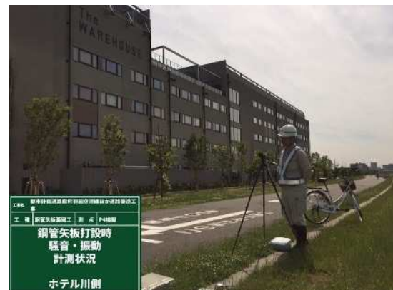
図 2.2.27 騒音振動計測状況 (多摩川サイクリングロード沿い)
