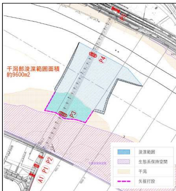
図 2.2.12 H29 年度工事の浚渫範囲
