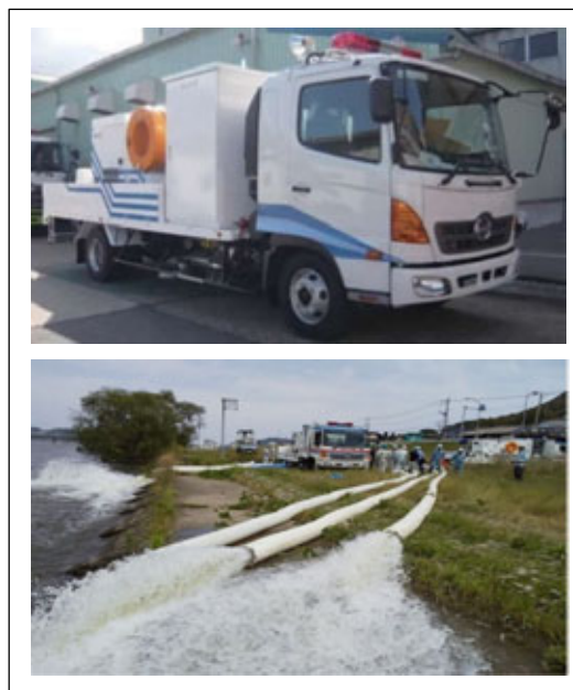
図 12-5-2 排水ポンプ車と対応イメージ
