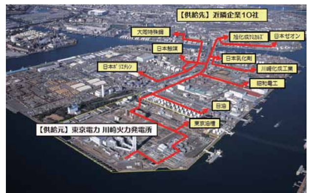
川崎スチームネットの蒸気供給配管網
