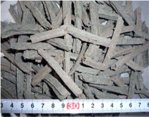
汚泥燃料化物
