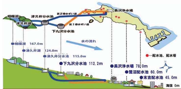
自然流下による水道システム
