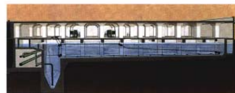
最終沈殿池 酸化分解した汚泥を沈殿させ、きれいになった上澄み水だけを消毒し、麻生川へ放流します。
