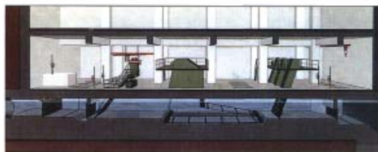
沈砂池 汚水中に含まれている重い土砂や大きなゴミ類を取り除く池で、大きなゴミはスクリーンで取り除きます。
