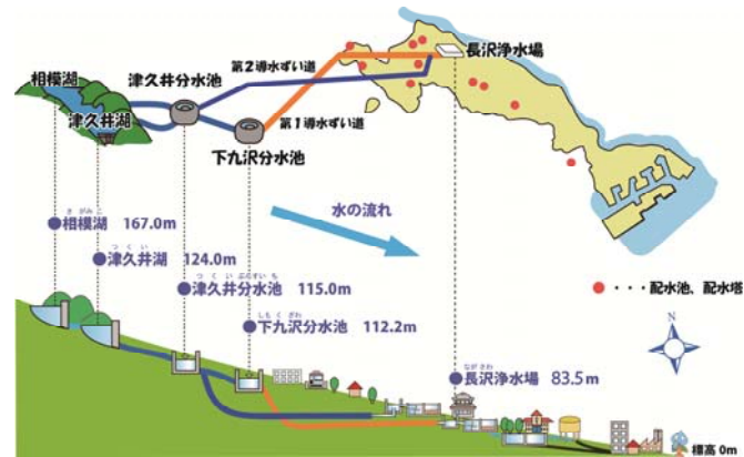
自然流下による水道システム
