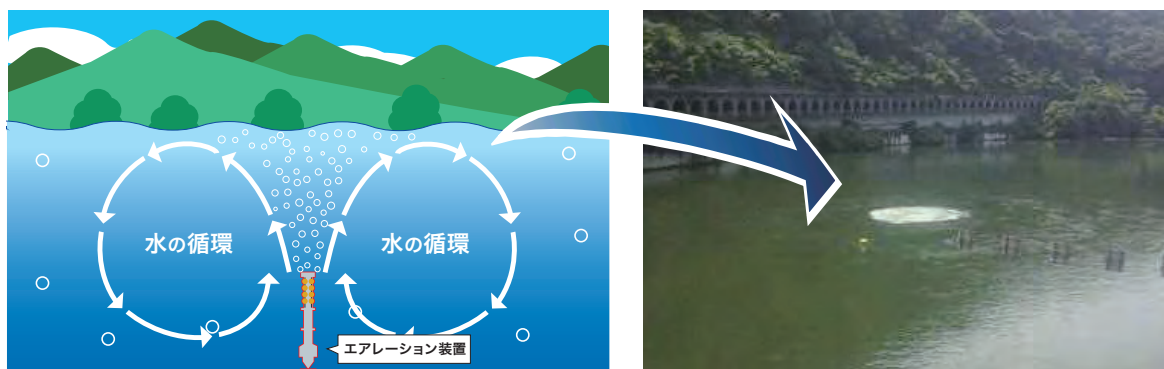
エアレーション装置
