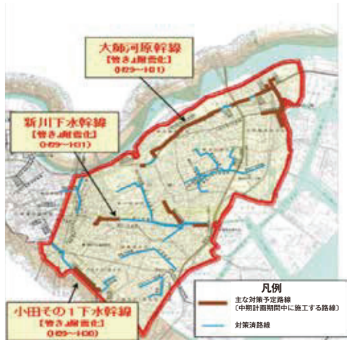
川崎駅以南の重要な管きよの耐震化
