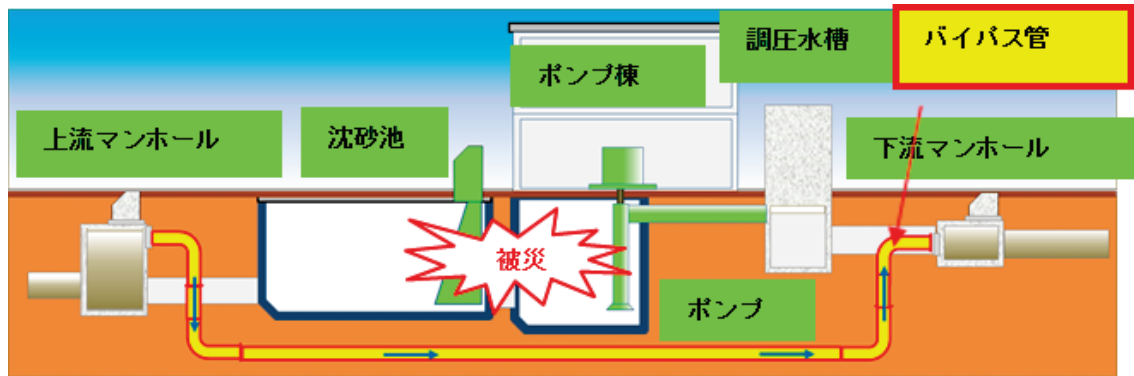
地震時における減災対策としての揚水機能の確保イメージ (ポンプ場のバイパス管によるバックアップ対策)
