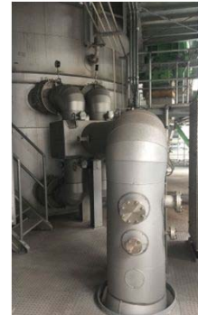
一酸化二窒素と窒素酸化物の削減効果を確認する試験設備
