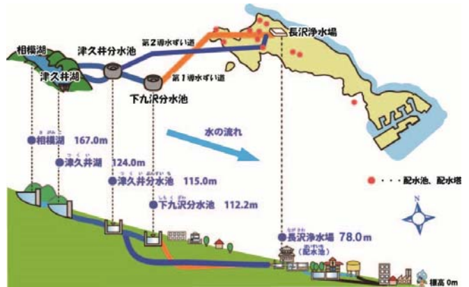
自然流下による水道システム
