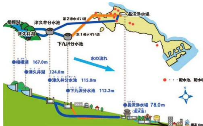
自然流下による水道システム
