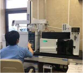
ガスクロマトグラフ-質量分析計による水道水の水質検査
