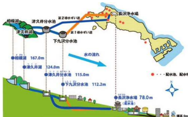
自然流下による水道システム
