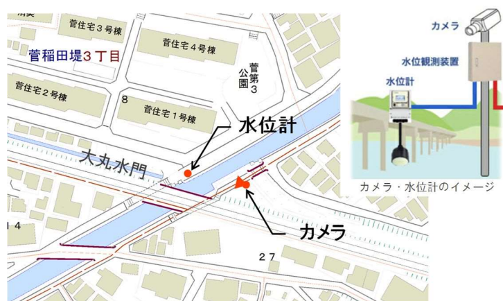
図 7-4-4 水位計、カメラの設置平面図
