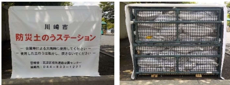
図 7-4-6 土のうステーション(設置事例)
