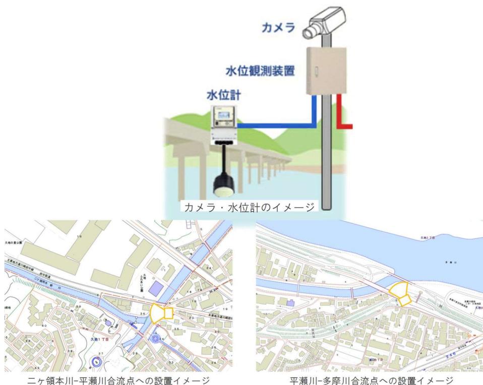
図 6-4-4 カメラ設置イメージ
