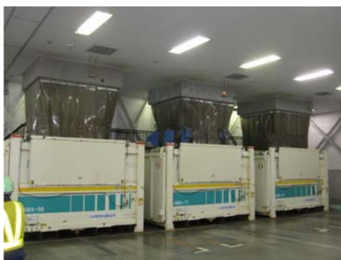
資源物鉄道輸送用コンテナ： コンテナの上部に資源物投入ホッパ（黒い部分）が確認できるが、その上のフロアが投入口になっている。
