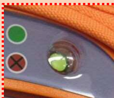
図 53 正常・異常を示す AED のインジケータの例①（日本光電；カルジオライフ AED-2100）
