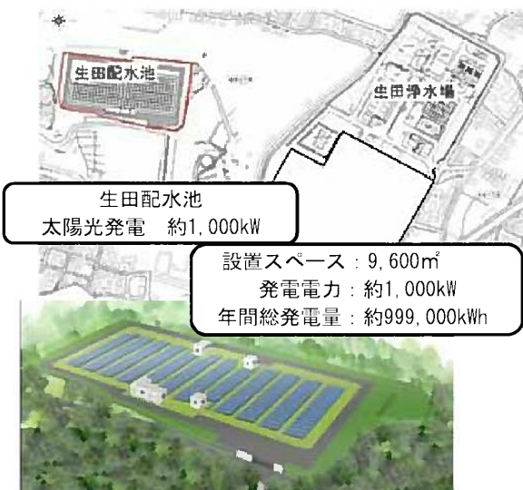
生田浄水場（生田配水池）
