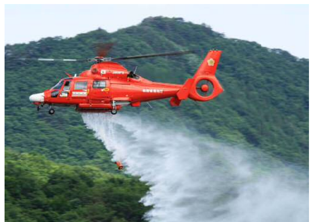
空中消火装置による消火活動
