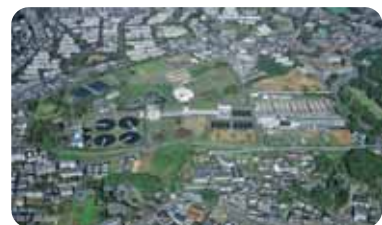
長沢浄水場 昭和29年6月に通水を開始しました。相模川を水源とし、処理方式は急速ろ過方式、施設能力は24万m 3 /日です。現在、再構築計画により沈でん池などを建設中です。
