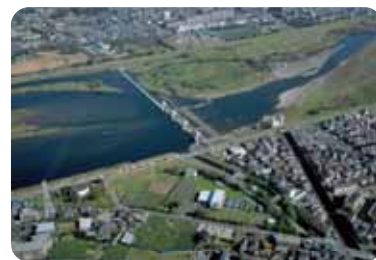
稲田取水所 上河原取水堰堤により二ヶ領用水に分水された多摩川の河川水を稲田取水所で取水しています。
