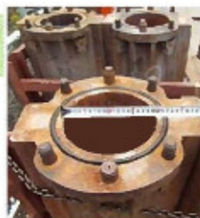
【写真③】排泥管(ロッド管φ200)
